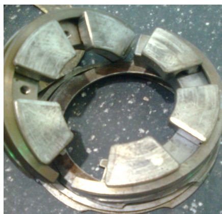
Рисунок 5 - Упорная часть штатного опорно-упорного подшипника ЦВД
