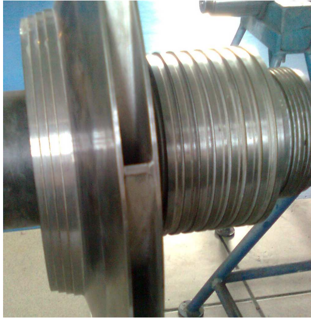
Рисунок 10 - Ступенчатая уплотняемая поверхность на рабочем колесе
